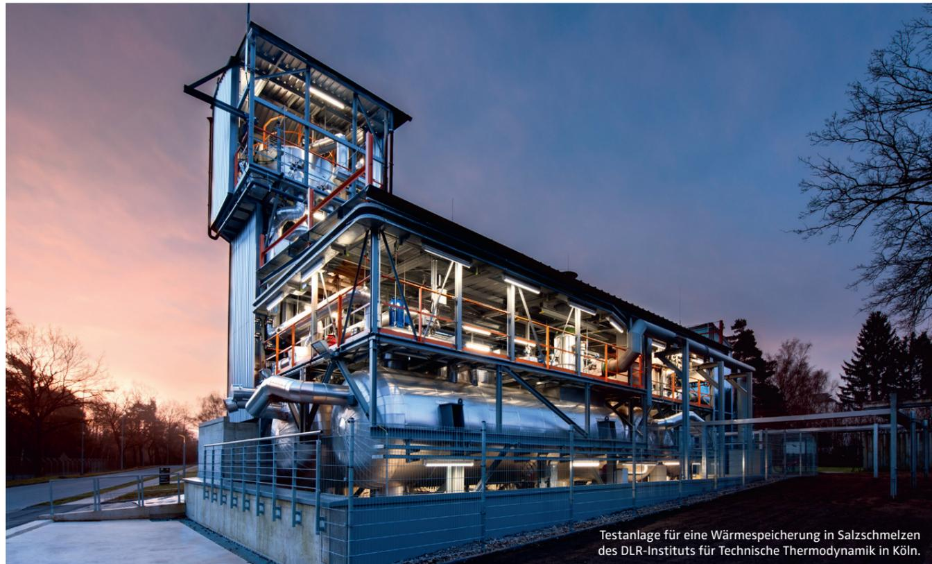
Testanlage für eine Wärmespeicherung in Salzschnmelzen des DLR-Instituts für Technische Thermodynamik in Köln.
