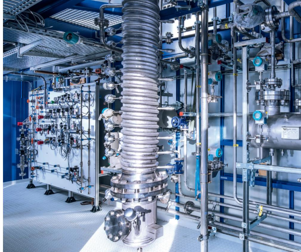
Ein elektrothermischer Energiespeicher mit Vulkangestein ist in der Lage, Wärme hoher Temperatur (z. B. 800 °C) zu speichern.
