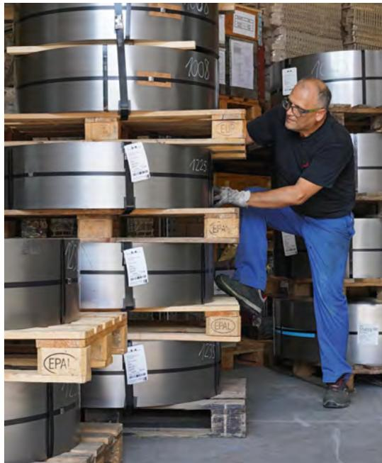
Aus den Blechrollen werden bei Zehnder in Gränichen jene Lamellen, die in den Heizkörpern möglichst viel Luft erwärmen.
