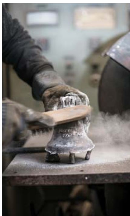
Ein Klangkörper entsteht: Der Glockenkern und die falsche Glocke bilden einen Hohlraum, in den die flüssige Bronze läuft. Nach dem Guss wird die Glocke – hier ein privates Geschenk – aus der Form befreit und in der Werkstatt bearbeitet.
